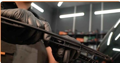
4 Odstranite metlico iz ročice brisalnika.
