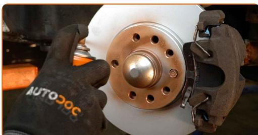
**60** Očistite površino zavornih kolutov. Uporabite čistilo zavor.
