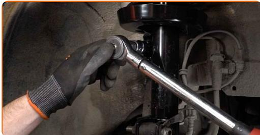
**58** Obdelajte pritrdilne elemente blažilnika. Uporabite bakreno mast.
