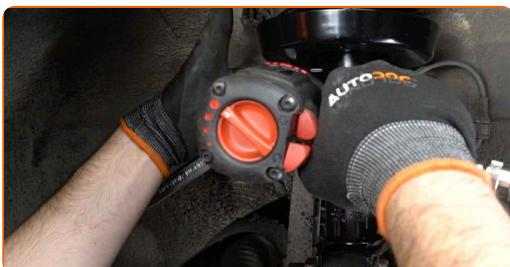
**57** Zategnite pritrdilni element, ki povezuje jarmov drog na blažilnik. Uporabite nasadni ključ №19. Uporabite navorni ključ. Zategnite ga do navora 60 Nm.
