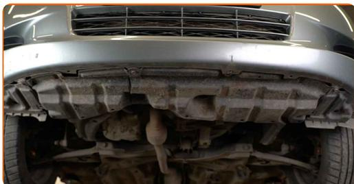
**3** Odvijte spodnje pritrdilne elemente odbijača. Uporabite nasadni ključ №10. Uporabite izvijač z zatikalom.
