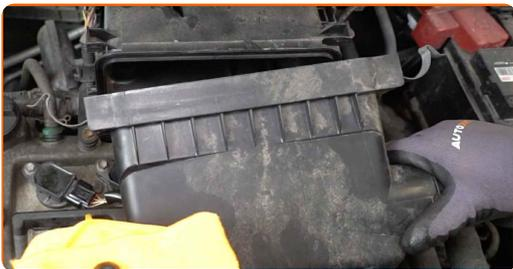
**5** Pokrijte cev za dovod zraka s krpo iz mikrovlaknen, da preprečite vnos prahu in umazanije v sistem.
