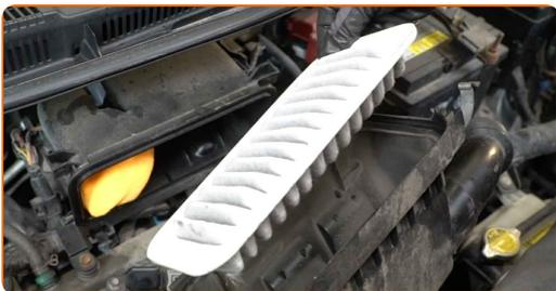
**7** Očistite pokrov zračnega filtra in ohišje.
