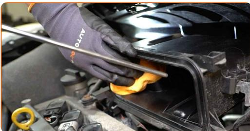
**8** Odstranite krpo iz mikrovlaknen iz cevi za dovod zraka.
