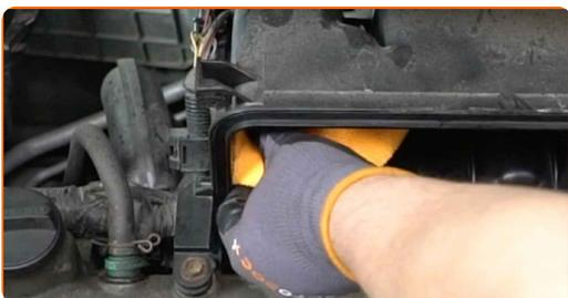
**6** Odstranite filtrirni element iz pokrova zračnega filtra.
