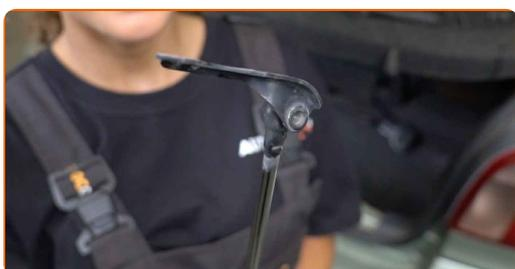
**6** Očistite sedež za namestitve plinske vzmeti prtljažnika. Uporabite čistilno krtačo iz najlona. Uporabite sprej WD-40.
