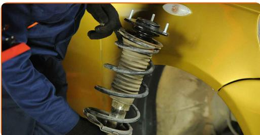
**19** Nastavite opornik amortizerja na orodju kompresorja.
