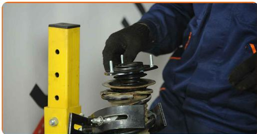
**34** Zategnite matico amortizerja. Uporabite nasadni ključ №17. Uporabite navorni ključ. Zategnite ga do navora 33 Nm.
