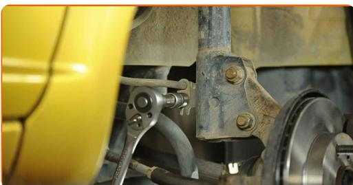
**8** Odstranite nosilec z opornika amortizerja.
