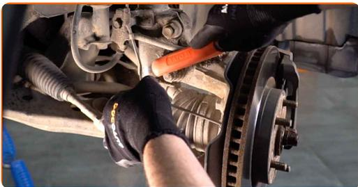
**10** Odvijte spodnji pritrdilni element, ki povezuje blažilnik s premnikom. Uporabite kombinirani ključ №19. Uporabite nasadni ključ №19. Uporabite izvijač z zatikalom.
