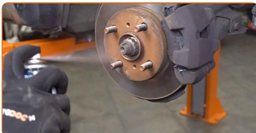
21 Očistite površino zavornih kolutov. Uporabite čistilo zavor.
