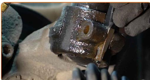
32 Spustite hidravlično dvigalo za menjalnik za 10-15 cm.
