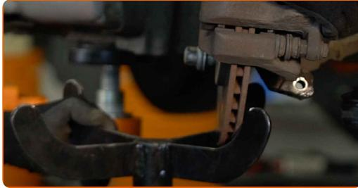
29 Očistite pritrdilni element, ki povezuje nosilni zgib s premnikom. Uporabite žično krtačo. Uporabite sprej WD-40.
