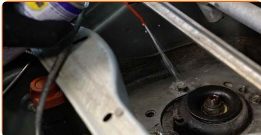
9 Sprostite zgornji pritrdilni element sedeža za namestitev blažilnika. Uporabite nasadni ključ №14. Uporabite izvijač z zatikalom.
