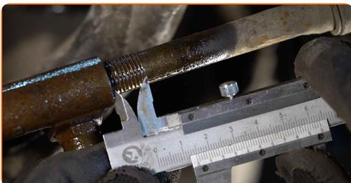
**10** Odvijte končno pritrdilno matico na volanskem členku. Uporabite kombinirani ključ №22. Uporabite izvijač z zatikalom.
