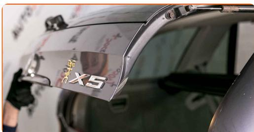
**40** Vzdignite zadnji del avtomobila in otdite podpornike.
