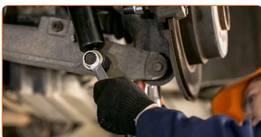
**45** Obdelajte pritrdilne elemente amortizerja. Uporabite bakreno mast.
