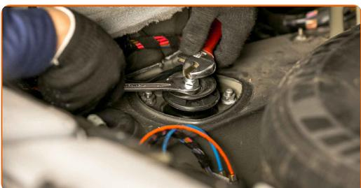
**30** Obdelajte pritrdilne elemente amortizerja. Uporabite bakreno mast.
