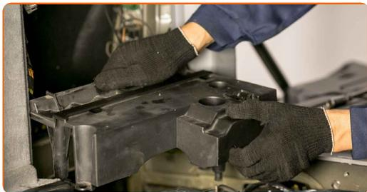
**19** Odstranite spojke. Uporabite ploščat izvijač.
