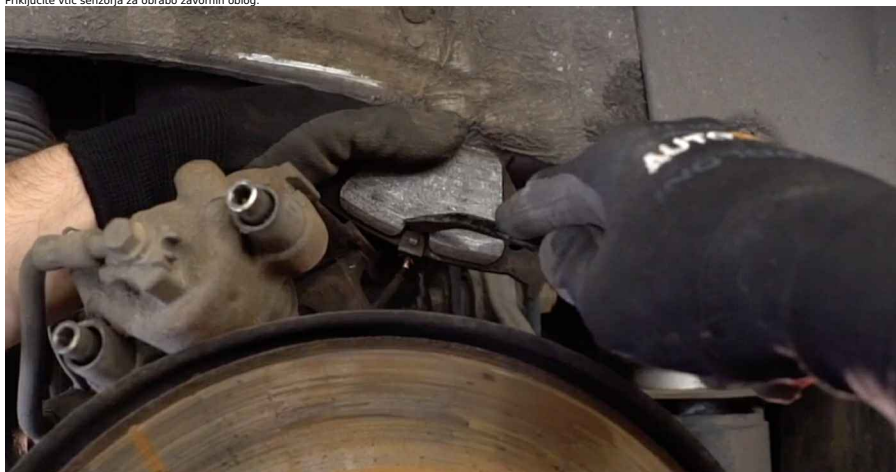
22 Namestite zavorno čeljust in jo privijte. Uporabite imbus št. H7. Uporabite navorni ključ. Zategnite ga do navora 30 Nm.
