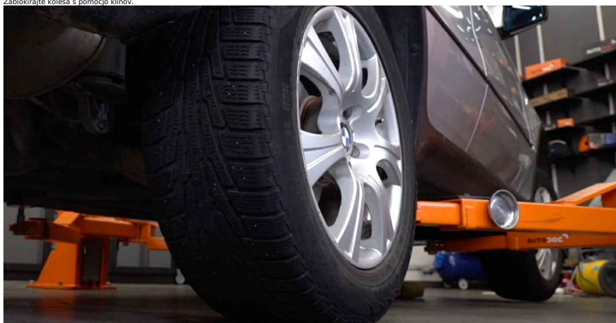
6 Odvijte vijake nastavka kolesa. Uporabite kolesni nasadni nastavek št. 19
