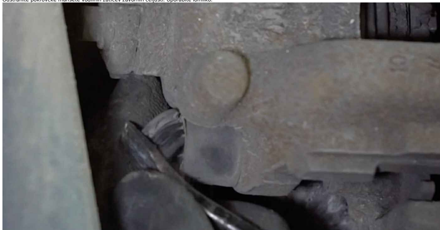
12 Odvijte pritrditve zavorne čeljusti. Uporabite imbus št. H7. Uporabite izvijač z zatikalom.
