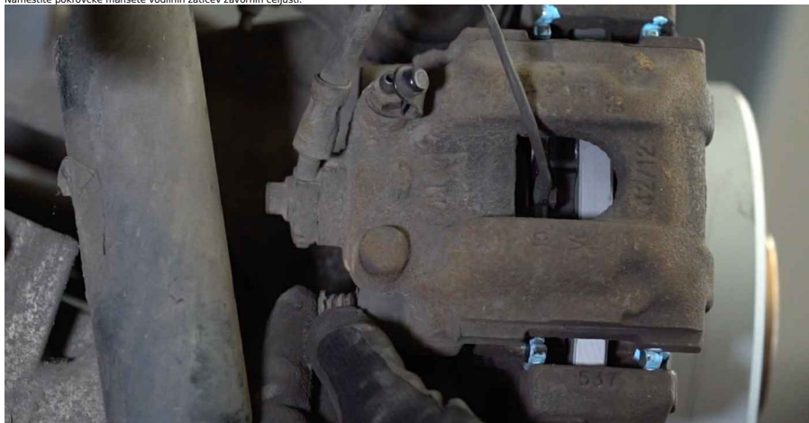
24 Namestite blokirno vzmet zavorne čeljusti.
