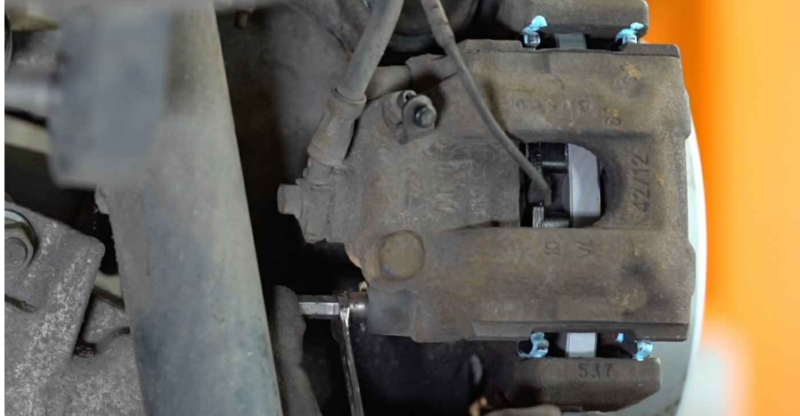
23 Namestite pokrovčke manšete vodilnih zatičev zavornih čeljusti.
