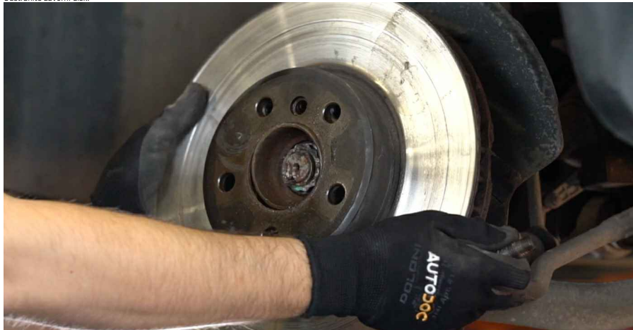
22 Očistite pesto. Uporabite žično krtačo. Obdelajte kontaktno površino. Uporabite bakreno mast.
