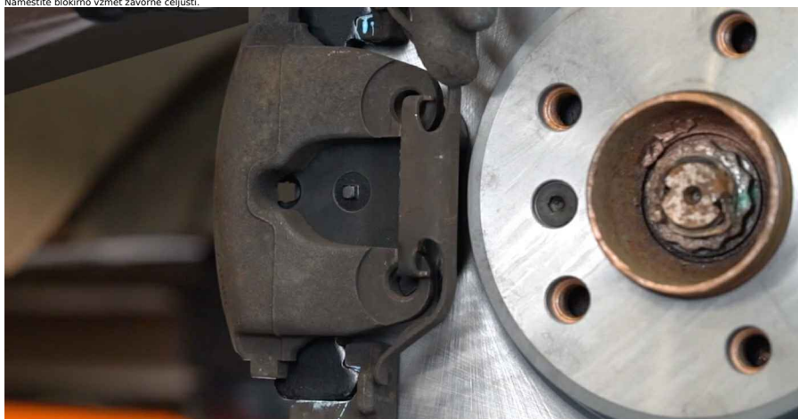
33 Očistite površino zavornih kolutov. Uporabite čistilo zavor.
