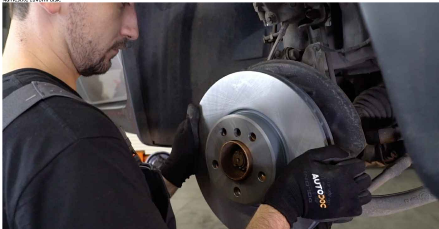
24 Zategnite pritrditve zavornega diska. Uporabite vijčni nastavek T30. Uporabite navorni ključ. Zategnite ga do navora 16 Nm.
