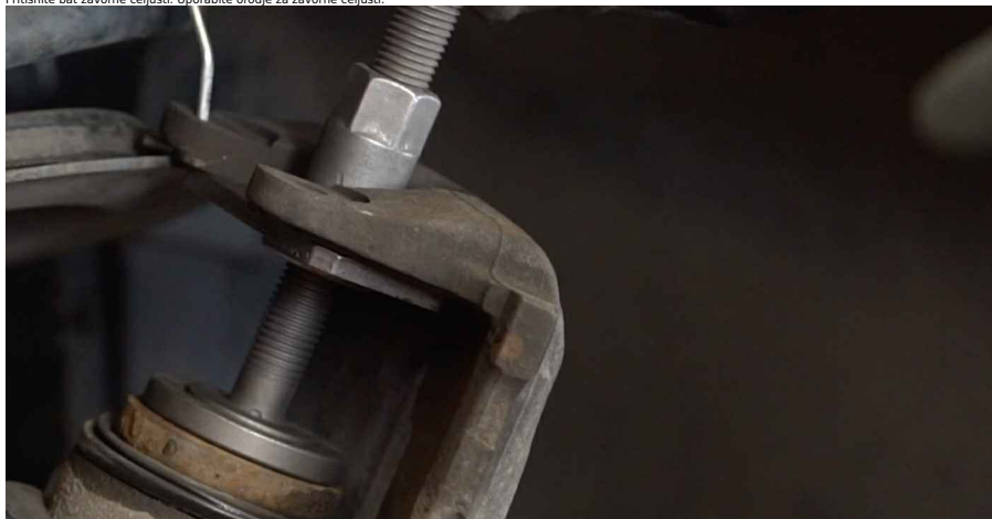
28 Očistite mesto namestitve čeljusti in njene nosilce. Uporabite žično krtačo. Uporabite čistilo zavor.
