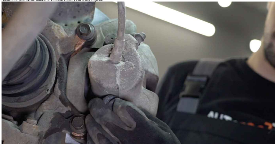
32 Namestite blokimo vzmet zavorne čeljusti.
