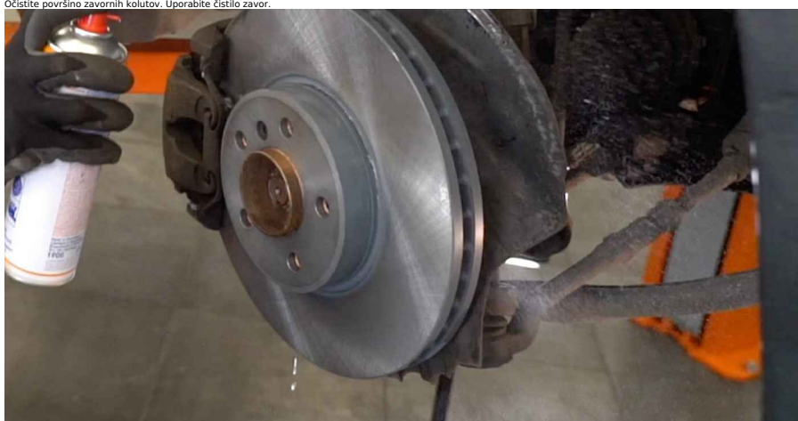
33 Očistite površino zavornih kolutov. Uporabite čistilo zavor.
