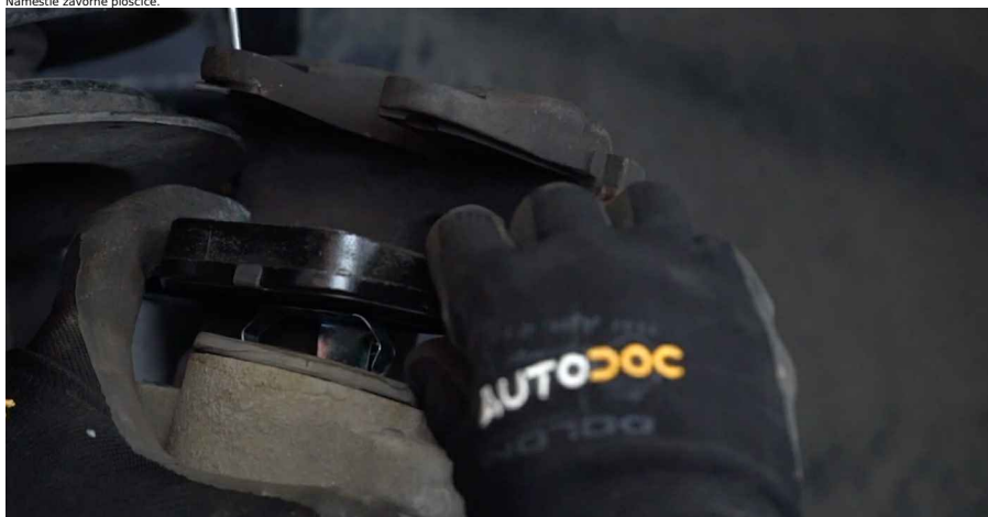
30 Namestite zavorno čeljust in jo privijte. Uporabite imbus št. H7. Uporabite navorni ključ. Zategnite ga do navora 30 Nm.
