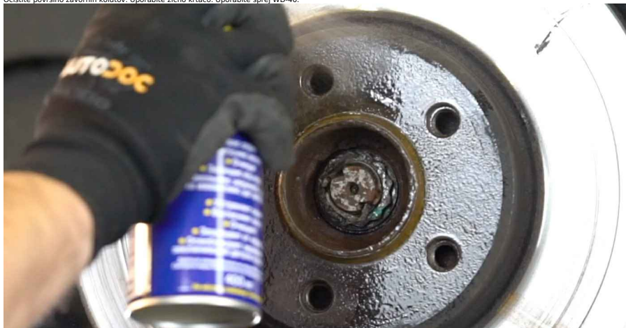
20 Odvijte pritrditve zavornega diska. Uporabite vijčni nastavek T30. Uporabite udami izvijač.
