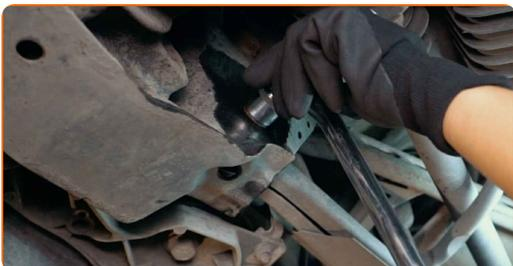
**12** Podprite zadnji premnik. Uporabite dvigalko s hidravličnim prenosom.
