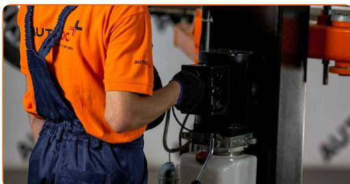
**2** Odvijte nosilec filtra za gorivo. Uporabite nasadni ključ №10. Uporabite izvijač z zatikalom.
