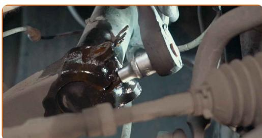
**20** Očistite vse sklepe prečnega vodila. Uporabite žično krtačo. Uporabite sprej WD-40.
