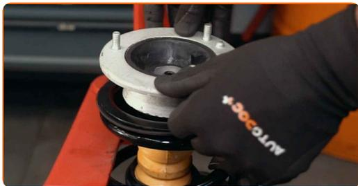
**33** Zategnite matico amortizerja. Uporabite nasadni ključ №19. Uporabite imbus št. H6. Uporabite navorni ključ. Zategnite ga do navora 64 Nm.
