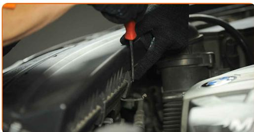
7 Snemite pokrov filtra. Uporabite ploščat izvijač.
