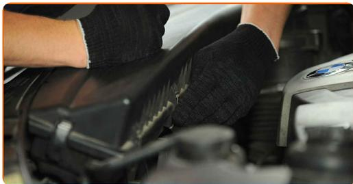
13 Privijte objemko, ki povezuje cev zračnega filtra na nastavek dušilnih loput. Uporabite ploščat izvijač.
