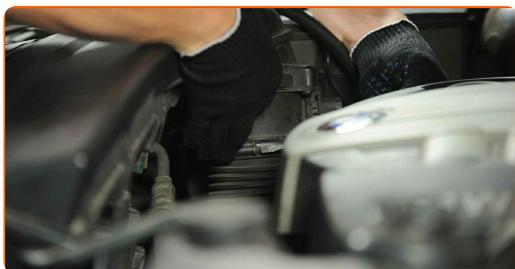
14 Vključite konektor senzorja za masovni pretok zraka.
