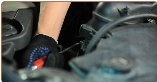
6 Sprostite sponke pokrova zračnega filtra. Uporabite ploščat izvijač.
