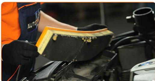
9 Očistite pokrov zračnega filtra in ohišje.
