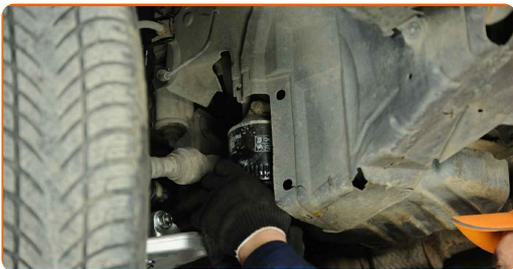
**4** Odložite stari oljni filter v posodo.
