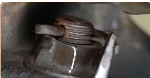
**10** Očistite vse sklepe prečnega vodila. Uporabite žično krtačo. Uporabite sprej WD-40.
