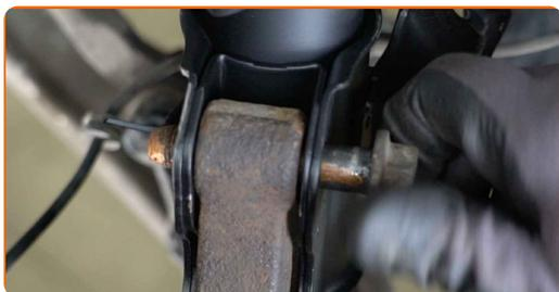
**41** Pritrdite spodnje pritrdilne elemente, ki povezujejo blažilnik in premnik. Uporabite kombinirani ključ №17. Uporabite nasadni ključ №19. Uporabite navorni ključ. Zategnite ga do navora 140 Nm.
