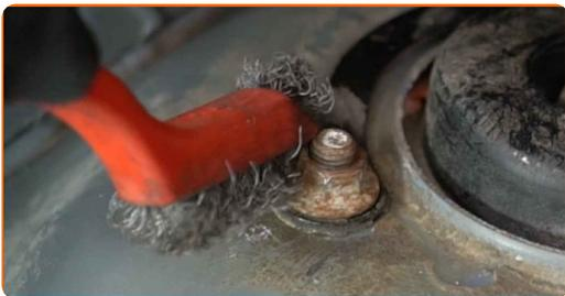
**4** Sprostite matico droga vzmetne noge. Ne odvij je popolnoma. Uporabite nasadni ključ №17. Uporabite izvijač z zatikalom.
