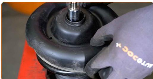
**32** Namestite zgornji nosilec opornika in ležaj nosilca opornika.
