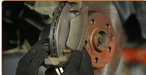
Menjava: zavornih ploščic – VW Transporter VI Minibus (SGB, SGG, SGJ).
