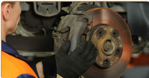
Menjava: zavornih diskov – VW Transporter VI Minibus (SGB, SGG, SGJ).
