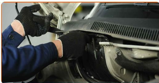
**66** Zategnite pritrdilne vijake zaščitnega pokrova. Uporabite vijačni nastavek T30. Uporabite izvijač z zatikalom.
