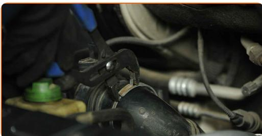
**32** Odklopite dovodno cev zraka z ohišja zračnega filtra.
