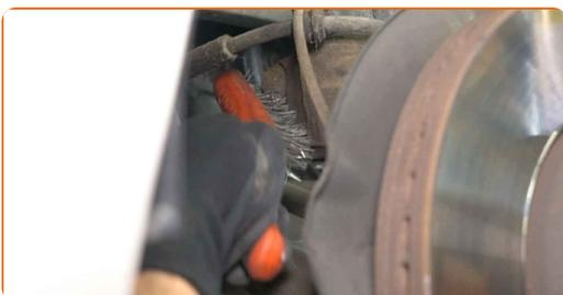
**21** Odvijte pritrdilne elemente, ki povezujejo vzmetno nogo s premnikom. Uporabite nasadni ključ №18. Uporabite izvijač z zatikalom.
