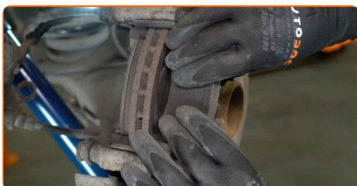
Menjava: zavornih ploščic – VW Transporter V Minibus (7HB, 7HJ, 7EB, 7EJ, 7EF, 7EG, 7HF, 7EC). Nasvet AUTODOC strokovnjakov:
