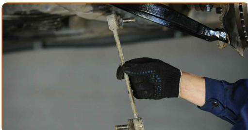
**Menjava: končnika stabilizatorja – VW Transporter V Minibus (7HB, 7HJ, 7EB, 7EJ, 7EF, 7EG, 7HF, 7EC). Strokovnjaki priporočajo:**
