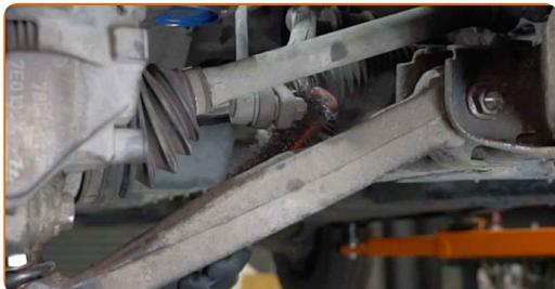
7 Odvijte pritrdilni element, ki povezuje jarmov drog na blažilnik. Uporabite kombinirani ključ №19. Uporabite imbus št. H5. Uporabite izvijač z zatikalom.
