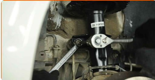
8 Odvijte pritrdilni element, ki povezuje jarmov drog na palico stabilizatorja. Uporabite kombinirani ključ №19. Uporabite imbus št. H5. Uporabite izvijač z zatikalom.
