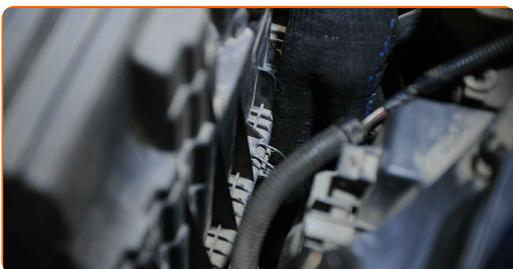
**67** Vključite konektor senzorja za masovni pretok zraka.
