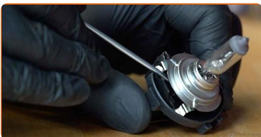
Menjava: žarnica glavnega žarometa – VW Transporter T5 Minibus (7HB, 7HJ, 7EB, 7EJ, 7EF, 7EG, 7HF, 7EC). AUTODOC priporočja:
