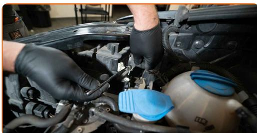
**3** Odstranite nosilec žarnice tako, da ga obrnete za približno 30°. Odstranite nosilec iz nosilca žarometa.
