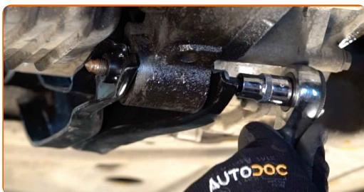
Menjava: nosilca motorja – VW Transporter T4 Van (70A, 70H, 7DA, 7DH).
