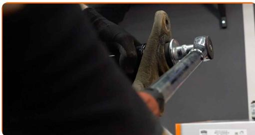
Menjava: amortizerja – VW Transporter T4 Keson / Podvozje (70E, 70L, 70M, 7DE, 7DL, 7D). Strokovnjaki priporočajo:
