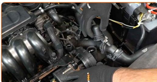
**4** Pokrijte kanale sekundarne zračne črpalke s krpo iz mikrovlaken, da preprečite vstop prahu in umazanije v notranjost.
