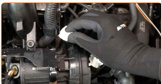
**5** Odklopite konektor sekundarne zračne črpalke.
