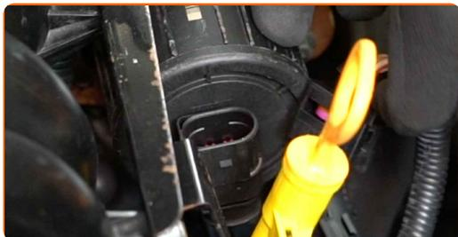
**6** Odvijte pritrdilne elemente, ki povezujejo sekundarno zračno črpalko z njenim nosilcem. Uporabite kombinirani ključ №10.
