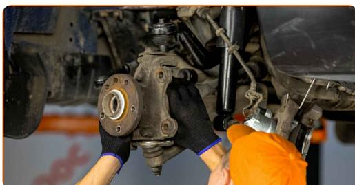
**30** Priključite zglob na krmilni členek. Uporabite ploščat izvijač.
