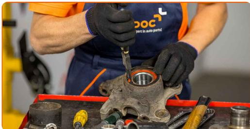
**28** Pritisnite pesto kolesa v notranji ležaj.. Uporabite komplet puše in ležaja gonilnika.
