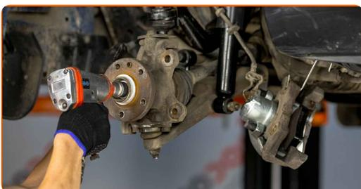
Menjava: kolesnega ležaja – VW Transporter IV Keson / Podvozje (70E, 70L, 70M, 7DE, 7DL). Nasvet AUTODOC strokovnjakov:
