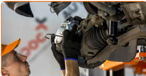
Menjava: kolesnega ležaja – VW Transporter IV Keson / Podvozje (70E, 70L, 70M, 7DE, 7DL). Nasvet:
