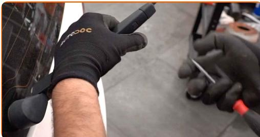
**5** Stisnite sponko. Uporabite ploščat izvijač. Odstranite metlico iz ročice brisalnika.
