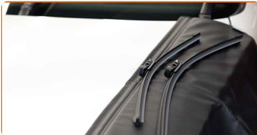
**4** Potegnite ročico brisalca stran od steklene površine dokler se ne ustavi.
