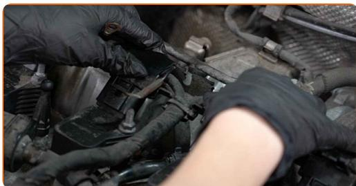
**19** Priklopite ozemljitvene žice na vžigalne tuljave in privijte pritrdilne elemente. Uporabite nasadni ključ №10. Uporabite izvijač z zatikalom.
