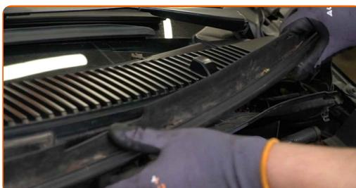
**4** Odvijte pritrdilne elemente plastičnega panela. Uporabite nasadni ključ №10. Uporabite izvijač z zatikalom.
