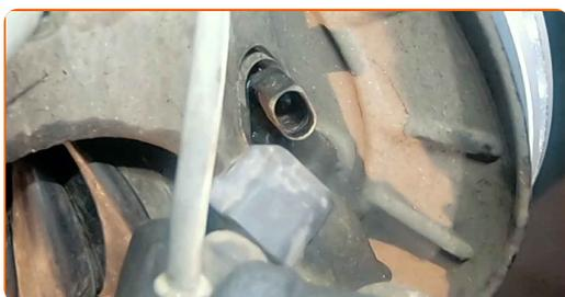
**7** Očistite pritrdilne elemente ABS senzorja. Uporabite žično krtačo. Uporabite sprej WD-40.
