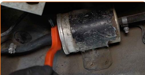
9 Sprostite pritrdilne objemke cevi filtra za gorivo. Uporabite nasadni ključ №7. Uporabite izvijač z zatikalom.
