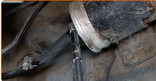
10 Odvijte nosilec filtra za gorivo. Uporabite nasadni ključ №10. Uporabite izvijač z zatikalom.
