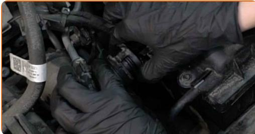
**4** Odklopite vakuumsko cev z ohišja zračnega filtra.
