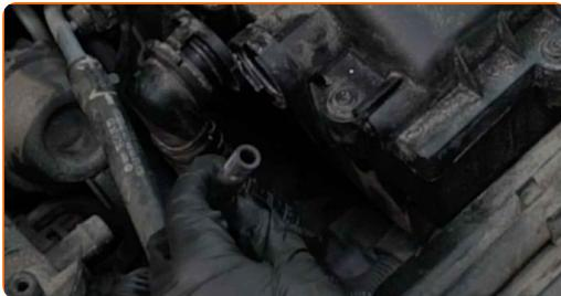
5 Odstranite pritrdilne vijke pokrova zračnega filtra. Uporabite vijačni nastavek T25. Uporabite izvijač z zatikalom.
