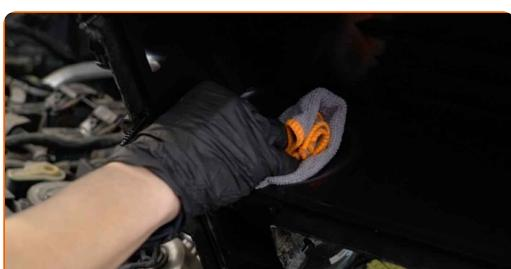
9 Očistite pokrov zračnega filtra in ohišje.
