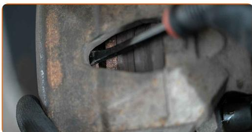
14 Odstranite pokrovčke manšete vodilnih zatičev zavornih čeljusti. Uporabite ploščat izvijač.
