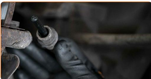
**20** Očistite staro mast in madeže rje, če so, z osnega vodila in manšet osnega vodila. Uporabite čistilo zavor.
