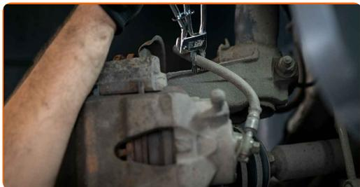
12 Odvijte zavorno cev iz zavorne čeljusti. Uporabite kombinirani ključ №11. Odmaknite zavorno cev. Privežite zavorno cev na karoserijo s kavljem ali kosom žice.
