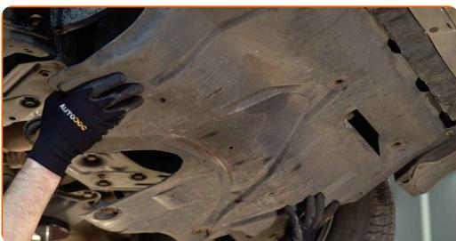
**8** Odvijte pritrdilne elemente nosilnega zgiba. Uporabite nasadni ključ №13. Uporabite udarni nasadni ključ.
