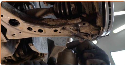
**9** Očistite vse sklepe prečnega vodila. Uporabite žično krtačo. Uporabite sprej WD-40.
