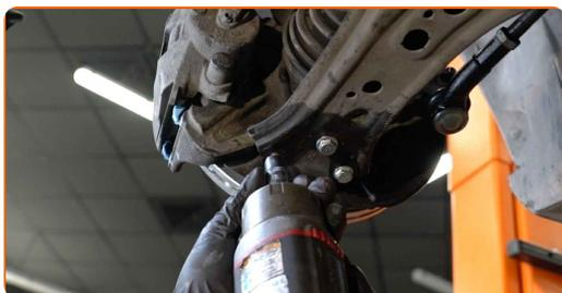
**18** Zategnite pritrditev krogličnega zgloba. Uporabite nasadni ključ №13. Uporabite navorni ključ. Zategnite ga do navora 20 Nm.+90°
