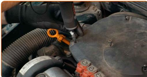
4 Odstranite ohišje zračnega filtra.
