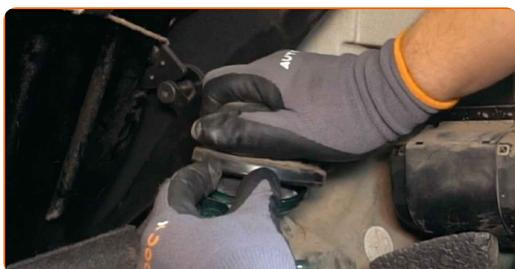
**9** Očistite zgornji pritrdilni element nosilca vzmetne noge. Uporabite žično krtačo. Uporabite sprej WD-40.
