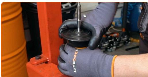
**37** Zategnite matico amortizerja. Uporabite kombinirani ključ №17. Uporabite nasadni ključ za blažilnik DDN№5,2. Uporabite navorni ključ. Zategnite ga do navora 20 Nm.
