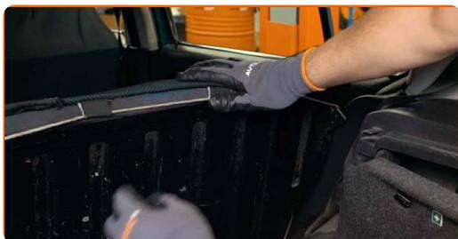
**6** Odvijte pritrdilne elemente stranskega plastičnega okrasnega panela. Uporabite vijačni nastavek T20. Uporabite nasadni ključ №7. Uporabite izvijač z zatikalom.
