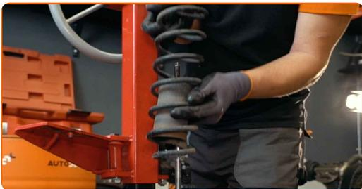
**31** Odstranite stari amortizer s kompresorja hidravlične spiralne vzmeti.
