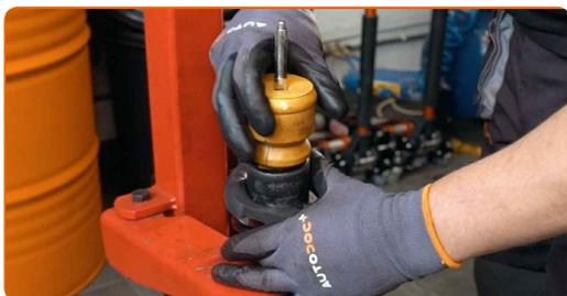
**36** Namestite zgornji nosilec opornika in ležaj nosilca opornika.
