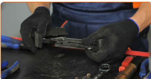
**17** Opravite dodatna demontažo zgornje držalne vzmeti in mehanizma za nastavitev. Uporabite kleščice.
