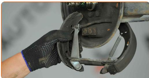
**15** Odstranite zadrževalno vzmet zavornih ploščic.
