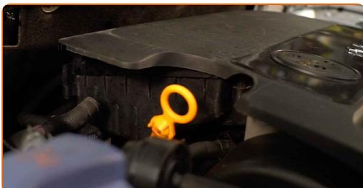
4 Odstranite pokrov motorja. Ohišje filtra za zrak je vgrajeno v pokrov motorja.
