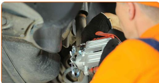
**21** Odstranite vijak črpalke za menjavo zavorne tekočine. Uporabite ključ za matice št. 10.
