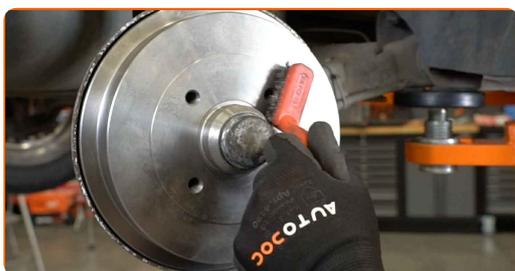
**31** Obdelajte površino, kjer se platišče kolesa dotika zavornega bobna. Uporabite bakreno mast.
