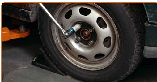
**4** Sprostite pritrdilni element pogonske gredi. Uporabite nasadni ključ №30. Uporabite udarni nasadni ključ.
