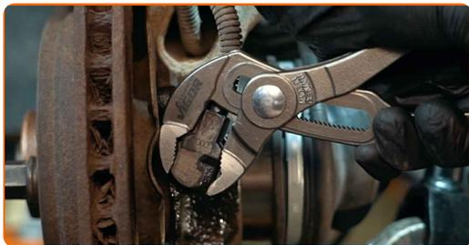
**11** Očistite vgradni prostor ABS-senzorja. Uporabite žično krtačo. Uporabite sprej WD-40. Uporabite čistilo zavor.
