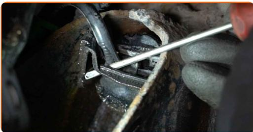
**16** Odklopite ABS-senzor. Uporabite mizarske klešče.
