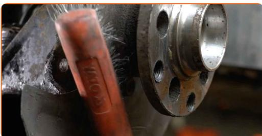
**18** Odvijte vijake pesta. Uporabite imbus št. H8. Uporabite udarni izvijač. Uporabite izvijač z zatikalom.
