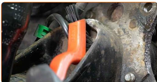
**15** Odklopite pritrdilni element ABS-senzorja. Uporabite ploščat izvijač.
