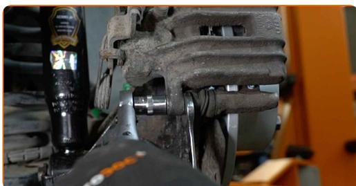
**35** Obdelajte površino, kjer se zavorni kolut stika s platiščem. Uporabite bakreno mast.
