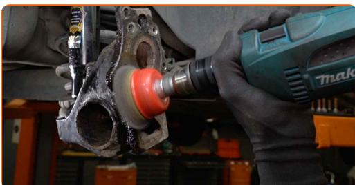
**22** Obdelajte pritrdilne elemente pesta. Uporabite bakreno mast.
