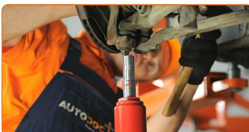
**37** Zategnite pritrdilni element, ki povezuje roke amortizerja s spodnjimi vilicami. Uporabite kombinirani ključ №18. Uporabite nasadni ključ №18. Uporabite navorni ključ. Zategnite ga do navora 90 Nm.
